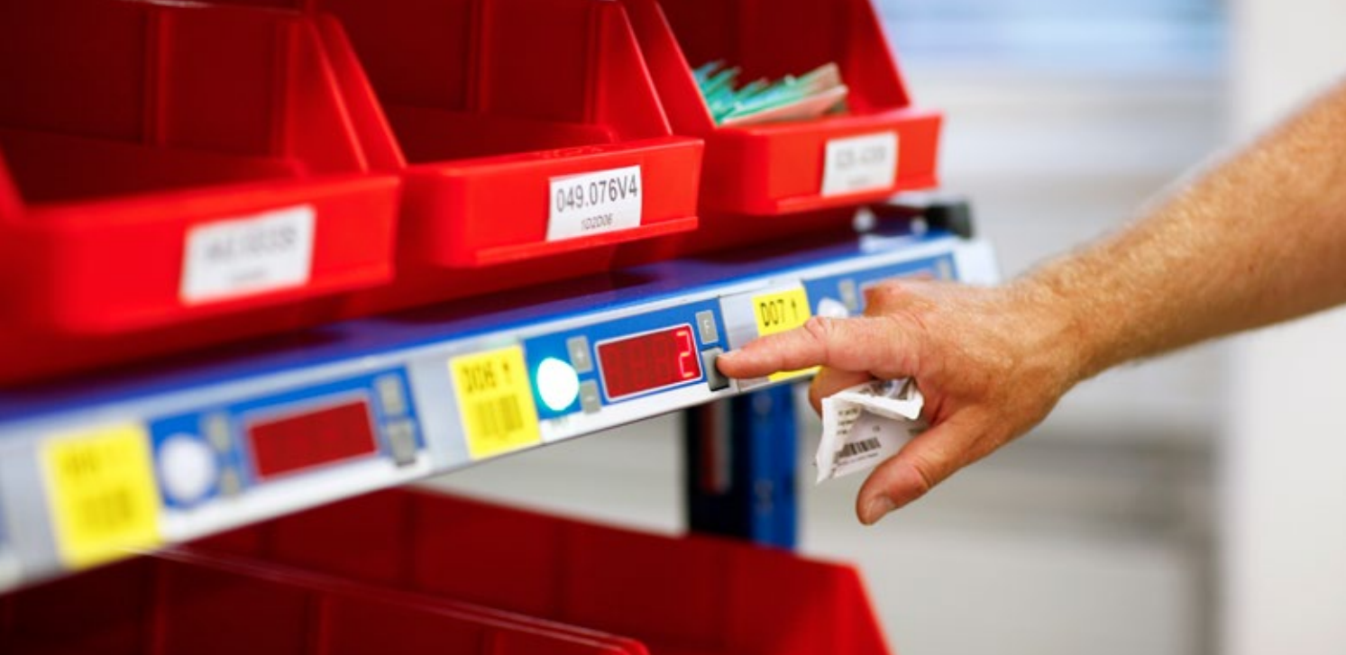
Beispielhafte Pick-by-Light-Fachanzeige mit Blickfangleuchte, Mengenanzeige, Quittiertaste, Funktions- und Korrekturtasten
