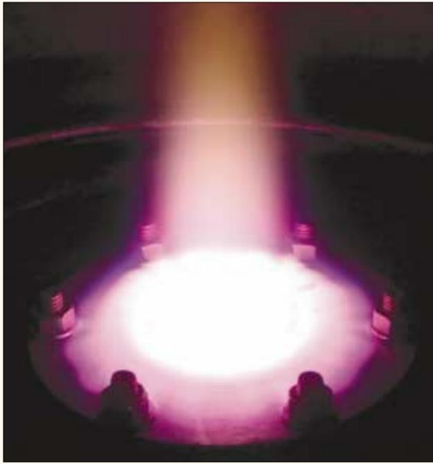
Bildung von Nanopartikeln in einem Plasmareaktor
